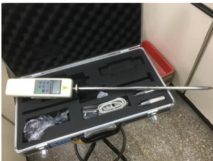
圖十四、數顯式土壤硬度計 CE-TYD-2
