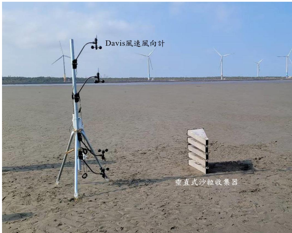
圖十九、垂直式沙粒收集器及 Davis 風速風向計
